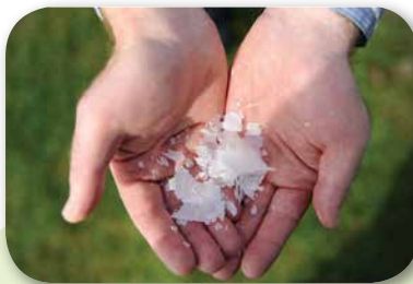
Slika 15: Fragmentirani okso-razgradljivi polimerni material (Loughborough University 2010).
